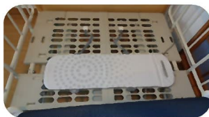
「眠りスキャンeye」 マットレスの下に置く センサー実機
